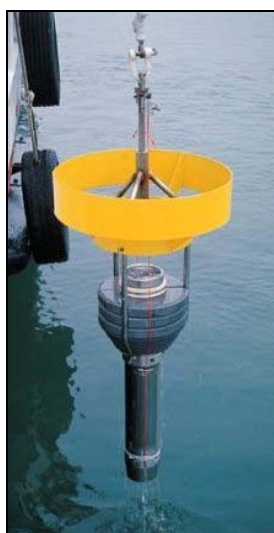
Foto 1. Carotiere "SW-104" (da: Magagnoli et al. 1995)
